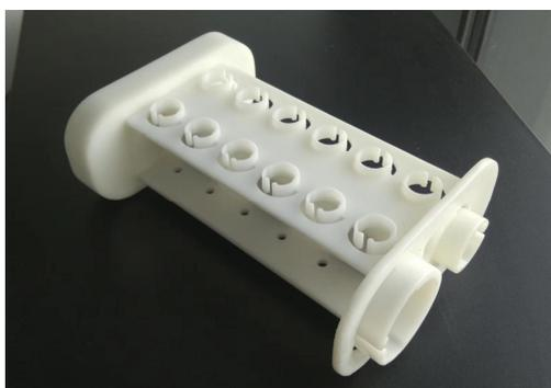
图：多功能磁力架照片
