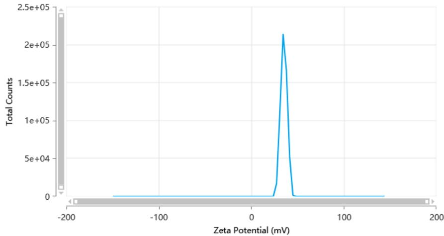
**图 3. MagBeads® 3 μm 氨基磁珠 Zeta 电位**
