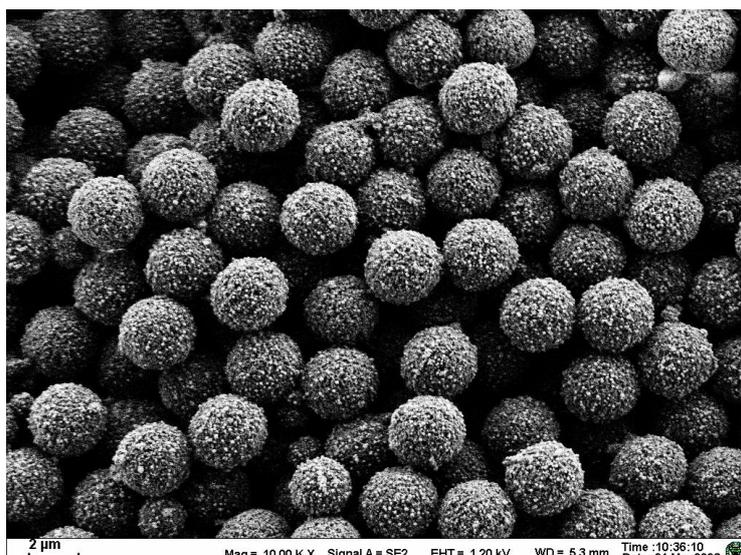
图 1. MagBeads® 3 μm 氨基磁珠 SEM 照片
